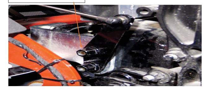
STEP 10: LOCATE THE BODY OF THE XG-17VHD BRACKET AND INSERT THE BOLTS PROVIDED AS SHOWN
