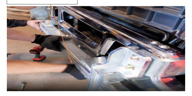
**STEP 13**: INSERT THE TOP NUTS AS SHOWN
