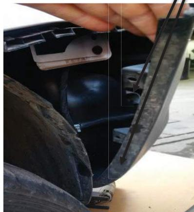
3) REMOVE BODY PINS FROM BUMPER/ FENDER ON PASSENGER SIDE TOTAL OF 5 THEN PULL BACK TO POP CLIPS AS SHOWN BELOW.
