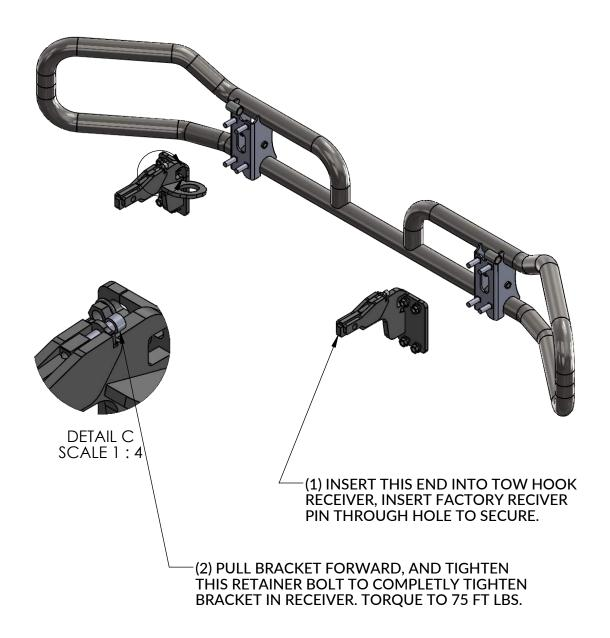
(3) INSTALL THE EX-GUARD BY INSERTING THE STUDS INTO THE BRACKET SLOTS, INSTALL THE FLANGE NUTS, TORQUE TO 150 FT LBS.
